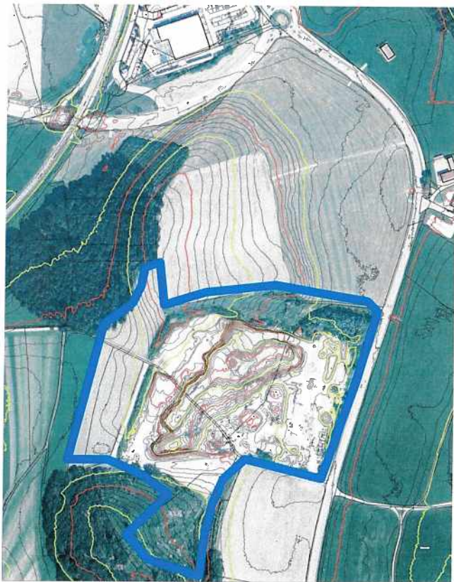
Abb. 8 Darstellung der Höhenentwicklung (Höhenlinien in 5-Meterschritten). Der Geltungsbereich des Bebauungsplanes ist blau dargestellt. Innerhalb der Kiesgrube ist nicht das ehemalige natürliche Gelände dargestellt, sondern eine Momentaufnahme eines Abbau- bzw. Verfüllstadiums. (Bildquelle Bayernatlas).
