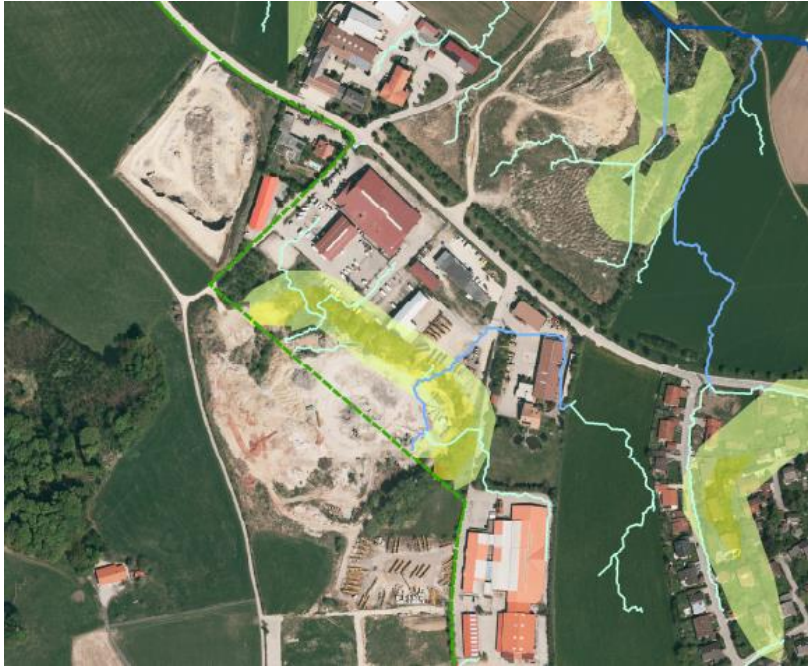
Abbildung 4: Fließrichtung des wild abfließenden Oberflächenwassers
